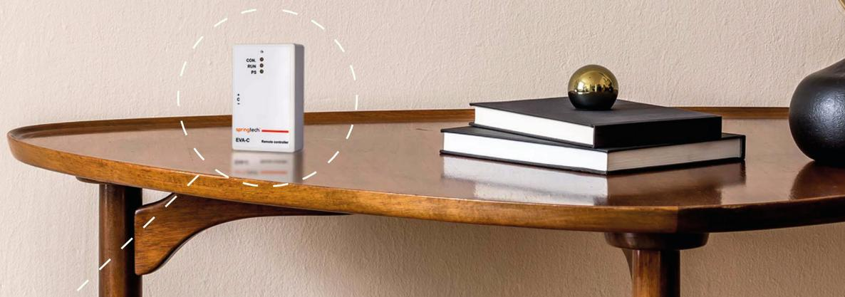
EVA-C è un dispositivo, alloggiato in un pratico contenitore posizionabile nel locale tecnico oppure su un mobile, che si collega al cloud tramite il Wi-Fi di casa e permette il controllo remoto di una qualsiasi centrale antintrusione. Aggiunge al sistema funzionalità di trasmissione allarmi, ascolto ambientale e controllo remoto tramite l'App myEVA.
